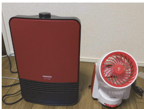
図3 電熱ヒータと搅拌送風機
