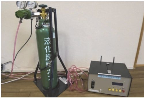
図 12 炭酸ガスボンベとガス流量制御装置
