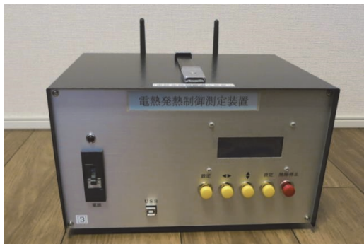
図2 電熱発熱制御装置
